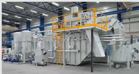
Precoat filter plant ASAV34,0 with sedimentation tank / Anschwemmfilteranlage ASAV34,0 2-fach mit Sedimentationsbecken
