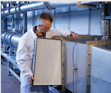
Test stand in acc. with / Prüfstand nach DIN EN 1822/ISO 29463
