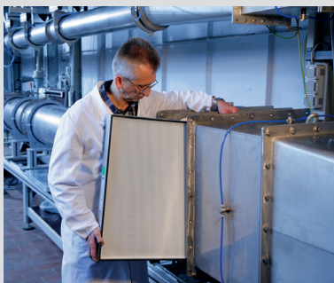
Test stand in acc. with DIN EN 1822 Prüfstand nach DIN EN 1822
