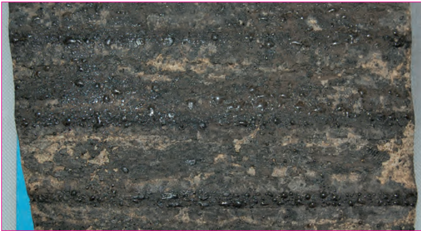
Abb. 3: Stark hygroskopischer Filterkuchen, Bildung von Wassertropfen auf der Anströmseite
