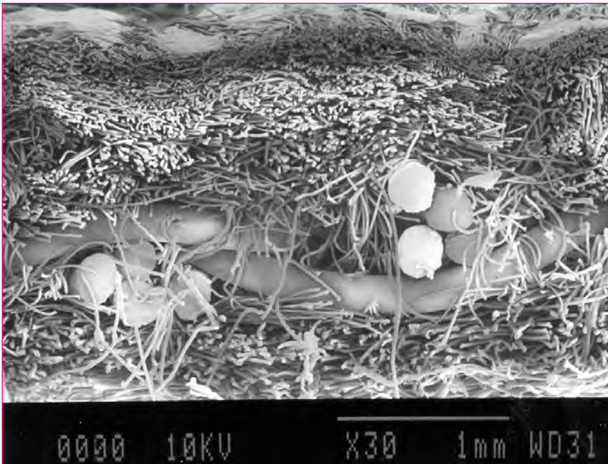
Abb. 4: Mikroskop-Querschnitt eines Nadelfilzes mit Mikrofasern in der Oberlage der Anströmseite (Kaskadenaufbau). Deutlich ist das Grundgewebe in der Mitte des Nadelfilzes erkennbar.
