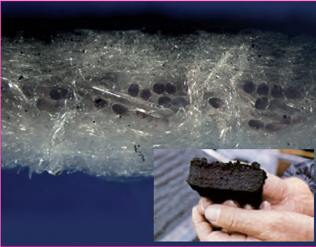
Abb. 5: Aktivkohle-Filtration mit Nadelfilz Filterbändern
